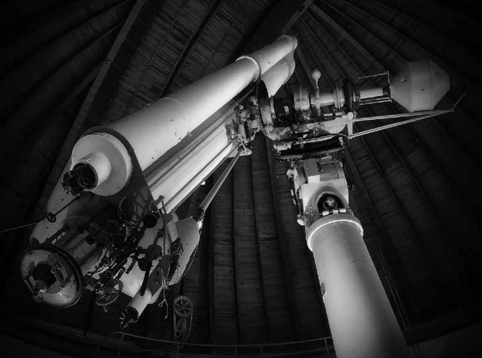
◀国立天文台三鷹キャンパスに残る口径65cm、焦点距離10mの屈折望遠鏡。望遠鏡が収められている建物は赤道儀室と呼ばれ、現在は歴史館としてさまざまな資料が展示されている。一般見学コースに指定されており、誰でも中を見ることが出来る(撮影/飯島 裕)。下は、65cm赤道儀望遠鏡で撮影された恒星のスペクトル。(関口鯉吉ほか、国立天文台)
