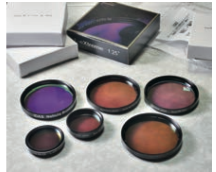
図2 デュアルナローバンド系フィルター 手持ちの各種フィルター。期待される効果は同様ですが、細かい特性がそれぞれ異なります。 IDAS Nebula Booster NB1 (NB1) φ48mm H α・O III・H βを透過 サイトロン Quad BP フィルターII / III (QBP II / III) φ48mm H α・O III・H β・S IIを透過 サイトロン Dual BP フィルター (DBP) φ48mm & 1.25" H α・O IIIを透過 OPTOLONG L-Extreme 1.25" H α・O IIIを透過
