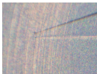
サンプルコンテナの開封や微粒子の確認作業は、キュレーションセンターで慎重に行われている。画像上の光る筋がマニピュレータ、先端の黒っぽい粒が微粒子である。黒い筋はマニピュレータの影。
