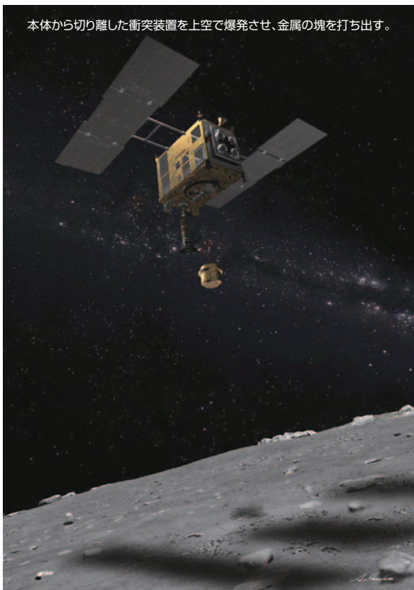
衝突装置で地表にクレーターを作る際には、多数の破片や粉塵が激しく飛び散る。その間、探査機本体は小惑星の反対側に避難する。
