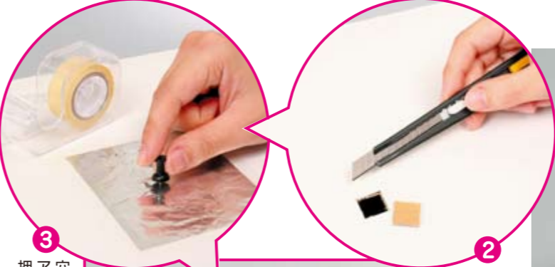
3 穴を開けた所にアルミホイルを貼り付けて、押しピンでピンホールを開ける
